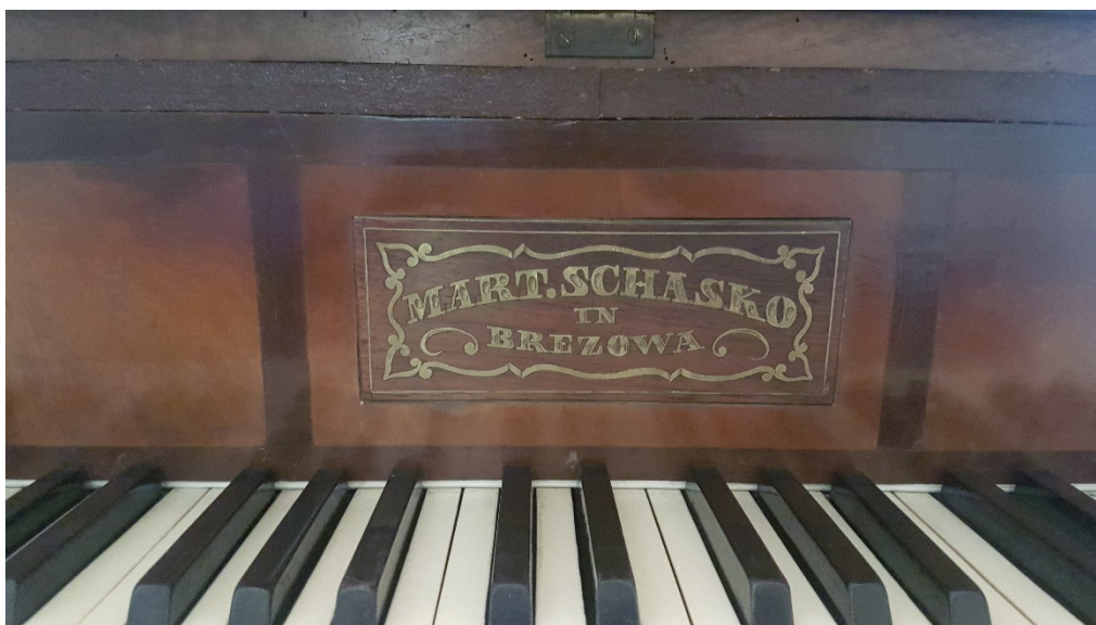
Firemný štítok Martina Šaška a klávesy II. man. s nepôvodným celuloidovým poťahom dlhších kláves.
