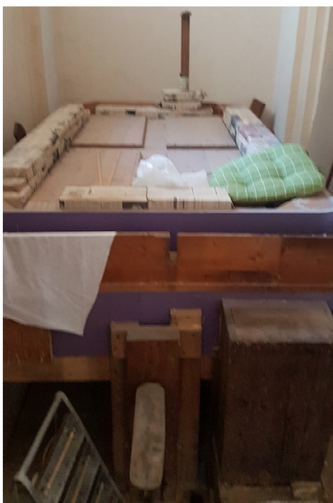
Nepôvodný plavákový mech na mieste starému mechu.
