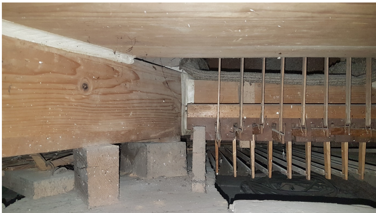
Vzduchový systém pod „veľkou vzdušnicou“ pedálu na Cis strane.
